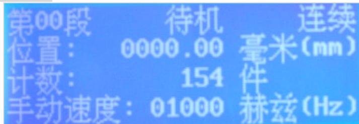
“第 00 段”：表示正在加工第几段程序，若为‘00’表示不在自动加工过程中；若为‘01（或 02，...）’表示正在运行自动加工过程中的第 01（或 02，...）段。
