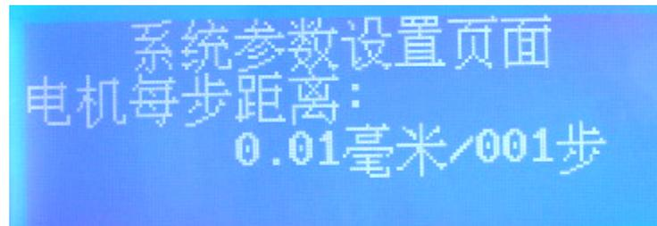
电机每步距离：指电机转一步（即控制器发一个步进脉冲）移动的距离，即电子齿轮比；
